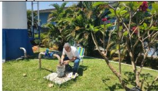
Acompanhamento do nível dinâmico no ensaio de recuperação do poço tubular profundo
