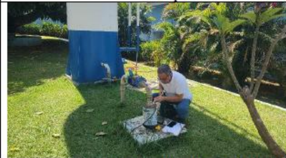
Acompanhamento do nível dinâmico no ensaio de recuperação do poço tubular profundo
