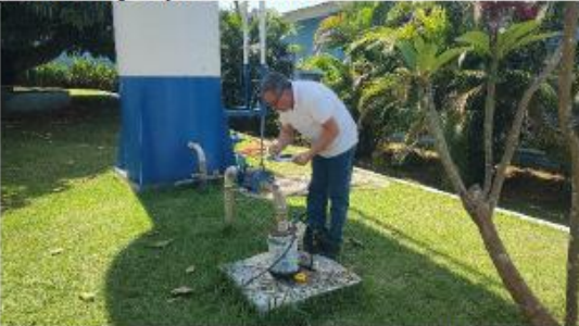
Acompanhamento do ensaio de vazão do poço tubular profundo
