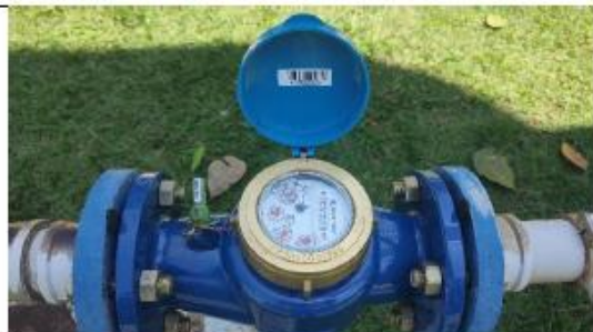
Ensaio de bombeamento para determinação da vazão – hidrômetro F25AK0001366 de 30 m³/h
